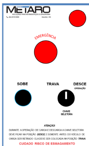
Figura 18: Quadro de acionamento
