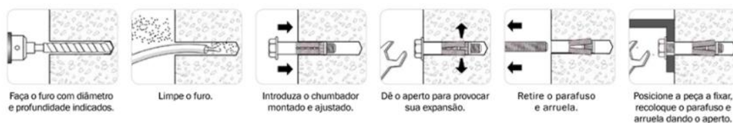
Figura 5: Orientações para aplicação dos chumbadores CBC (Fonte: Âncora, 2017).
