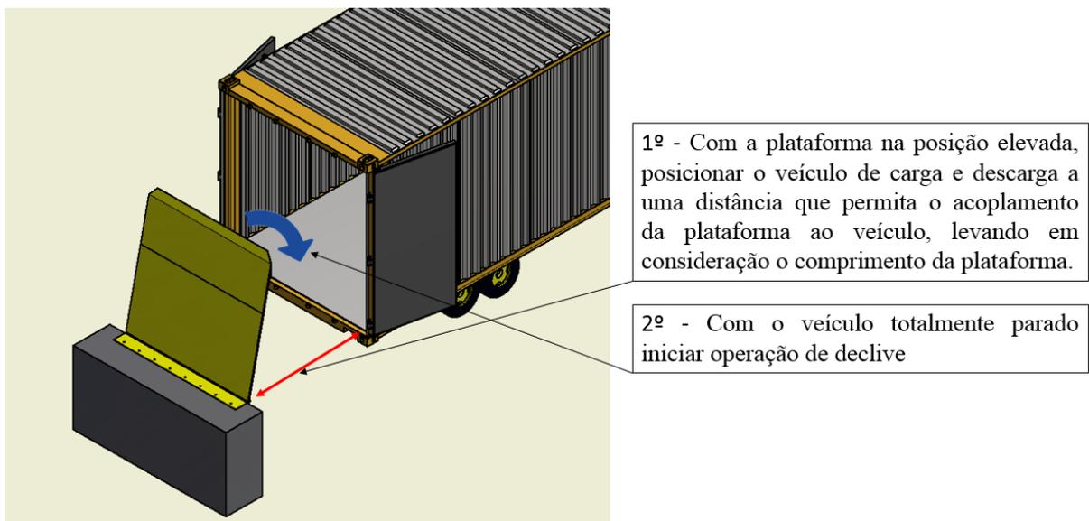
Figura 15: posicionamento do veículo de carga
