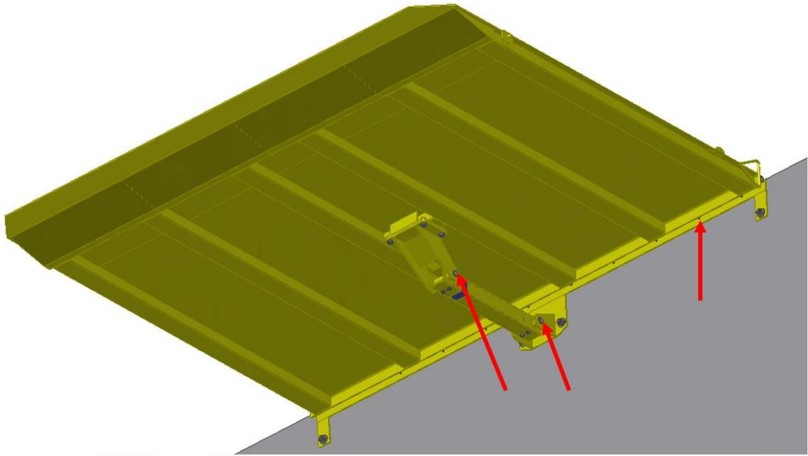
*Figura 17: Pontos de lubrificação da niveladora de doca avançada.*
