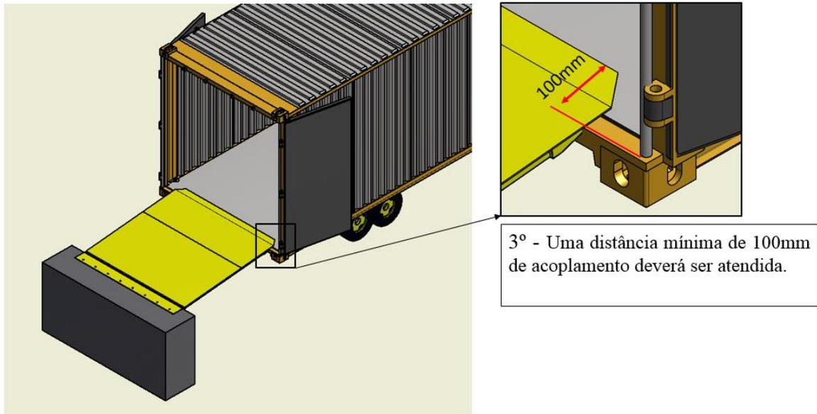
*Figura 16: Acoplamento da plataforma na carroceria.*
