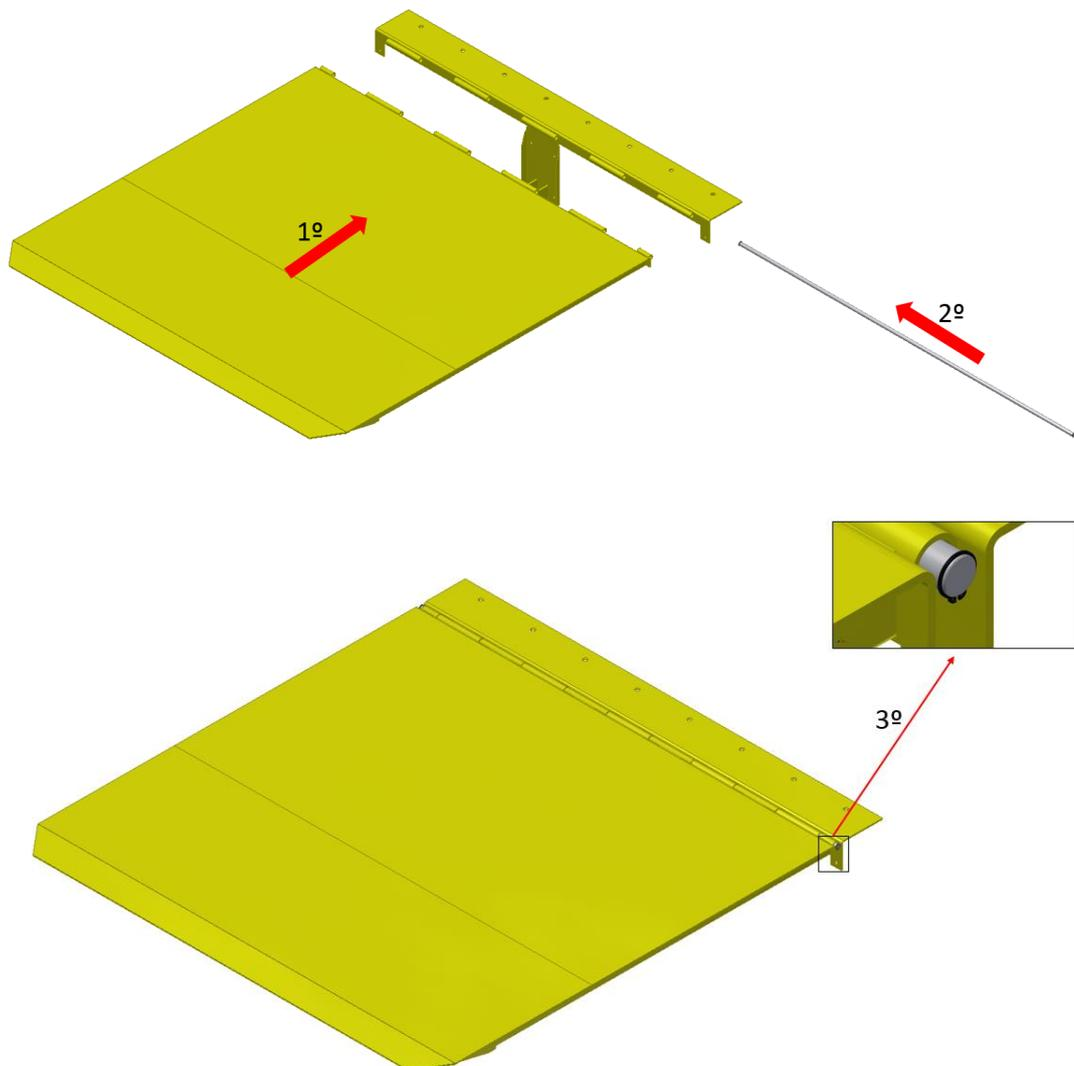
Figura 6: Montagem do eixo principal
