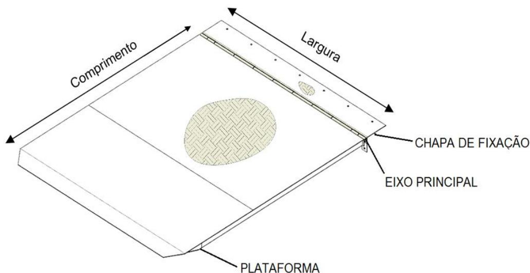
Figura 1: Dimensões da plataforma niveladora de doca avançada.
