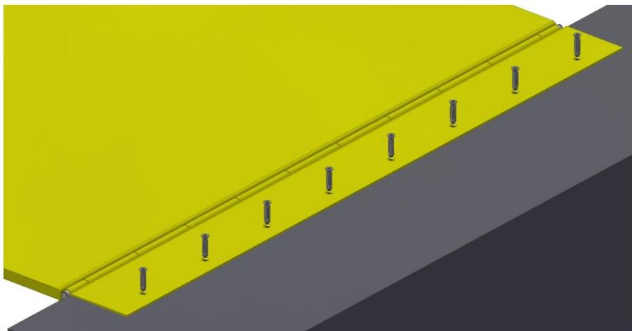
*Figura 8: Posicionamento dos chumbadores nos furos e aperto*
