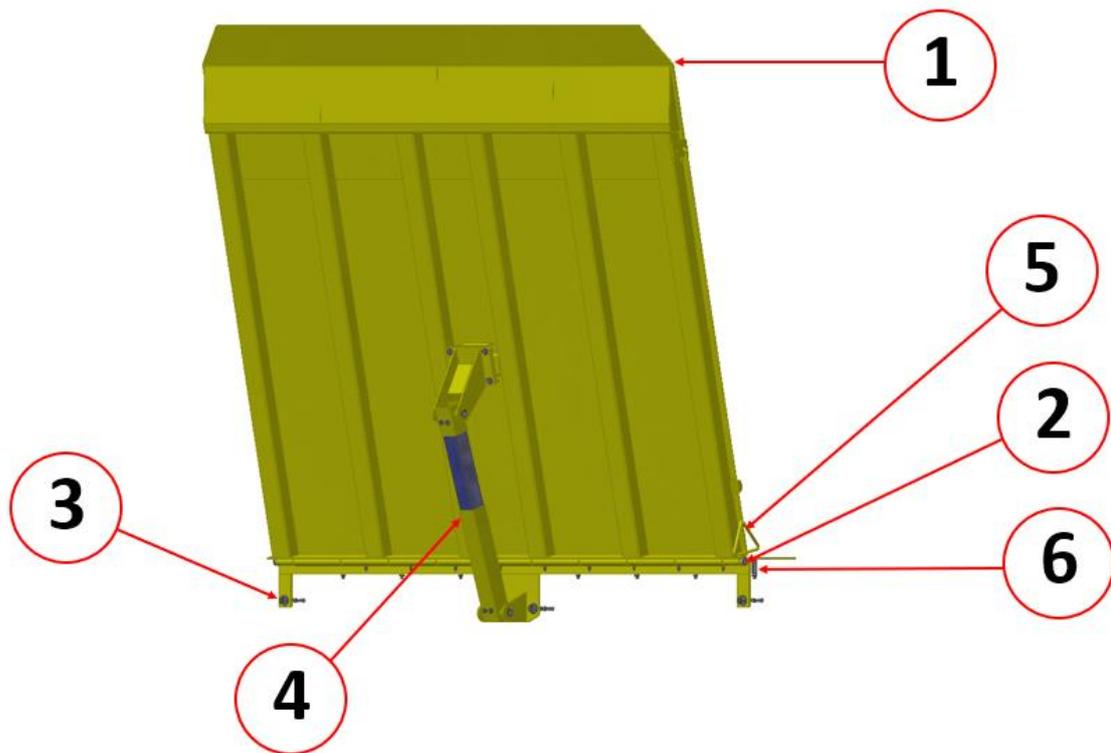
Figura 11: Plataforma niveladora de doca avançada mola a gás.
