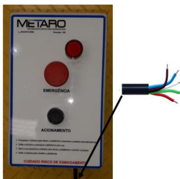
Figura 8: Ponto de passagem da alimentação com 5 vias
